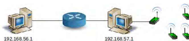
Figura 4. Arquitetura básica IPv4 para montagem de VPN via IPSec.
