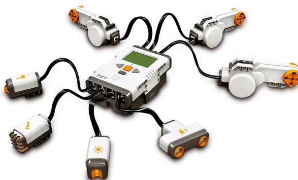
Figura 1. O NXT® – Brick conectado por cabos aos servomotores e sensores
