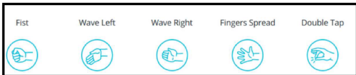
Figura 10. Gestos executados pelo usuário utilizando o Myo
