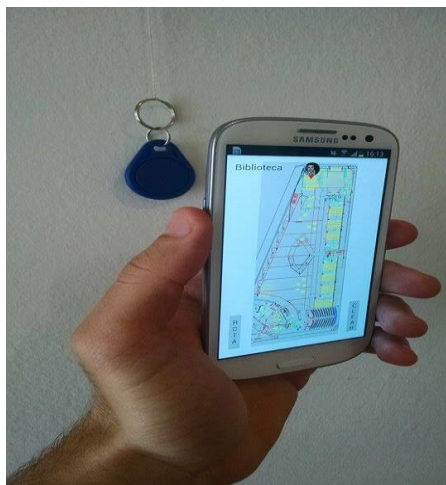
Figura 5. Usuário fazendo leitura da tag para obter sua localização que pode ser vista no mapa.
