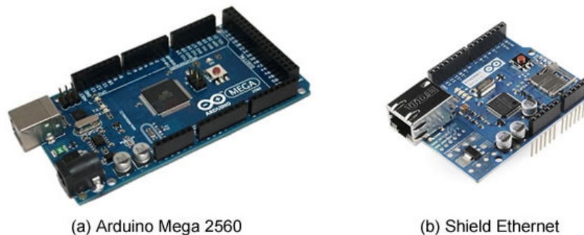
Figure 1. Dispositivos utilizados no protótipo. (a) Arduino Mega 2560; (b) Shield Ethernet
